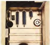
A sinistra: particolare sui connetti d'interfaccia. Facceso a quello della VGA è un po' scomodo. A destra: l'interruttore generale di alimentazione posto in posizione
